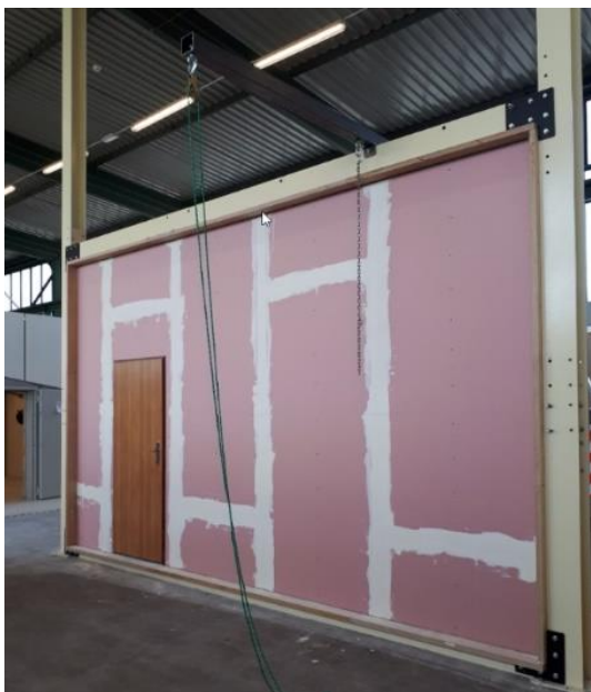
Fot. 4. Ściana wysoka do badań mechanicznych. W. Drozd
